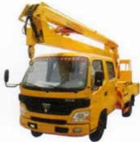
高空作业车 Aerial Platform Truck
