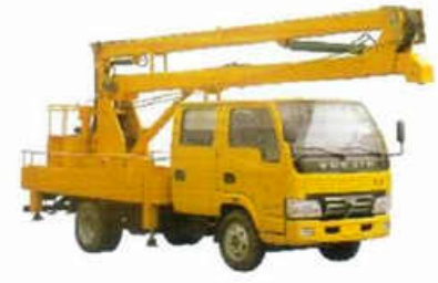
高空作业车 Aerial Platform Truck
