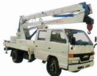
高空作业车 Aerial Platform Truck
